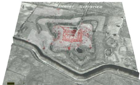
*Dieler Schanze bei Weener, Landkreis Leer: Projektion der mit geomagnetischer Prospektion erkundeten Messflächen auf ein digitales Oberflächenmodell. So werden die Strukturen der Innenbebauung und der Charakter der Befestigungsanlage besser verständlich (Bild: Christian Schweitzer).*
