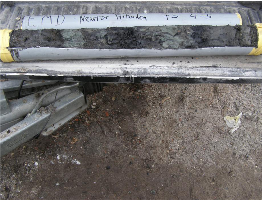
Abb. 11: Emden (14). Bohrkern F 5 vom Mitarbeiterparkplatz. Deutlich sichtbar sind die sich abwechselnden Auftragsschichten aus Mist und Klei (Bereich 4 bis 5 m unter GOK). (Foto: H. Prison)
