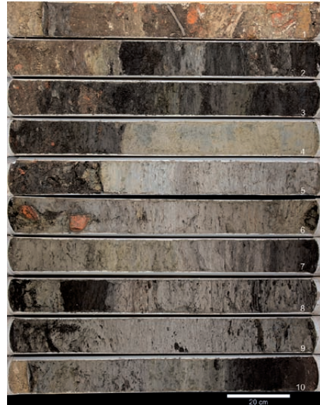
Abb. 12: Emden (10). Geöffnete Kerne der Bohrung Emden B01. Im oberen Abschnitt der meisten Einzelmeter ist durch die Bohrtechnik entstehender, schutthaltiger Nachfall zu erkennen. Die Wurtenaufträge sind durch hohe Organikgehalte und eine dunkle Farbe gekennzeichnet. Oberkante der Kerne jeweils links. (Foto: A. Folkers, NlHK)
