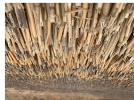
DÄMMUNG: SCHILF / ROHRKOLBEN ALS EINBLASDÄMMUNG ODER DÄMMPLATTEN
