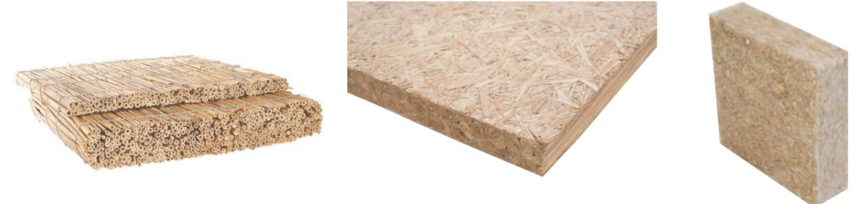
Schilfmatte als Zwischensparrendämmung (0,055 W/mK) z.B. von Hiss Reet
