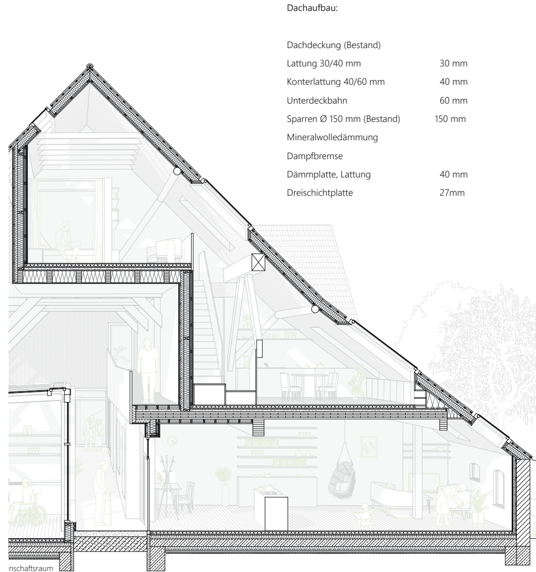
Abb. 105 Detailschnitt Scheune M 1.50
